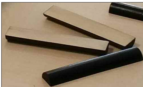
Figure 3: bâtonnets demi-sphériques bifaces dont la face bombée est noire et la face plate est blanche.
