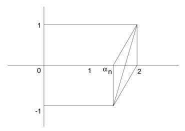
En pratique on calcule les  $(\alpha_n)_n$  de proche en proche en opérant de la manière suivante. Ayant calculé  $\alpha_n$ , on applique la méthode de Newton à la fonction  $\varphi(x) = x^n(x-2) + 1$  en partant de la valeur  $1 + \frac{\alpha_n}{2}$ , on en déduit alors  $\alpha_{n+1}$ .
