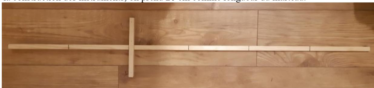
Pour une utilisation plus aisée avec les élèves, le côté de la flèche qui n'est pas gradué est recouvert d'un mètre ruban pour pouvoir lire précisément la position du marteau quelle que soit cette dernière.
