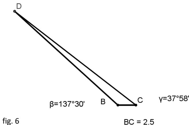
et C (fig. 6). On constate vite que la mesure de CD est très sensible aux petites variations des angles. Ce manque de précision, sensible lors d'un tracé sur papier, affecte aussi la fiabilité du résultat obtenu par les calculs.
